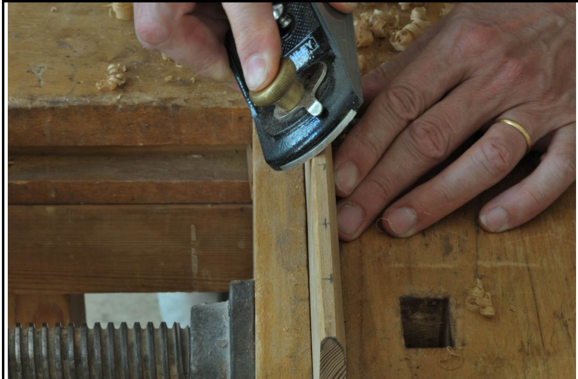
9 _Le chanfrein côté mors est réalisé au rabot. Il est plus large et plus prononcé sur la face extérieure.
