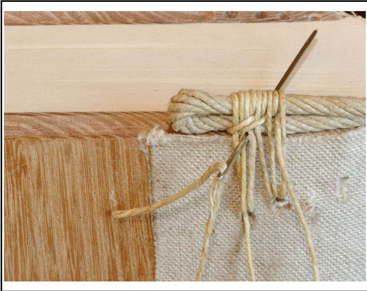
46_ On passe l'aiguille sous les deux septains en reculant de trois points.
