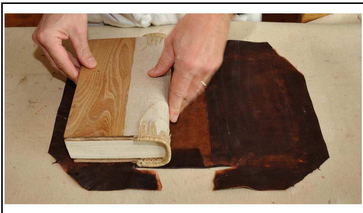
63_ On doit prévoir pour les chants et les coins une largeur de cuir suffisante pour que les remplis épousent bien la forme des rainures
