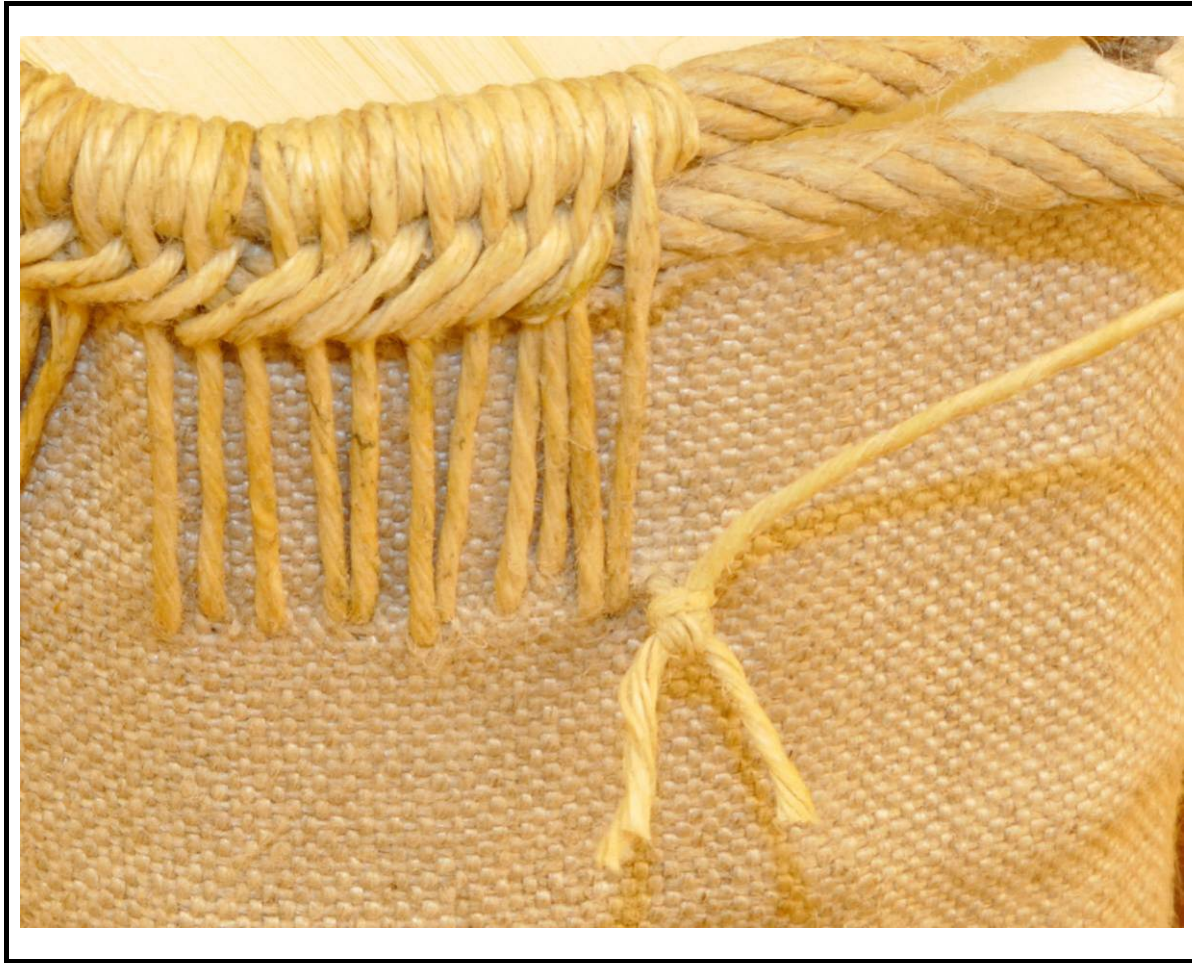
48_ La tranchefile nécessite en général plusieurs aiguillées, pour le raccord on pratique un nœud de tisserand.
