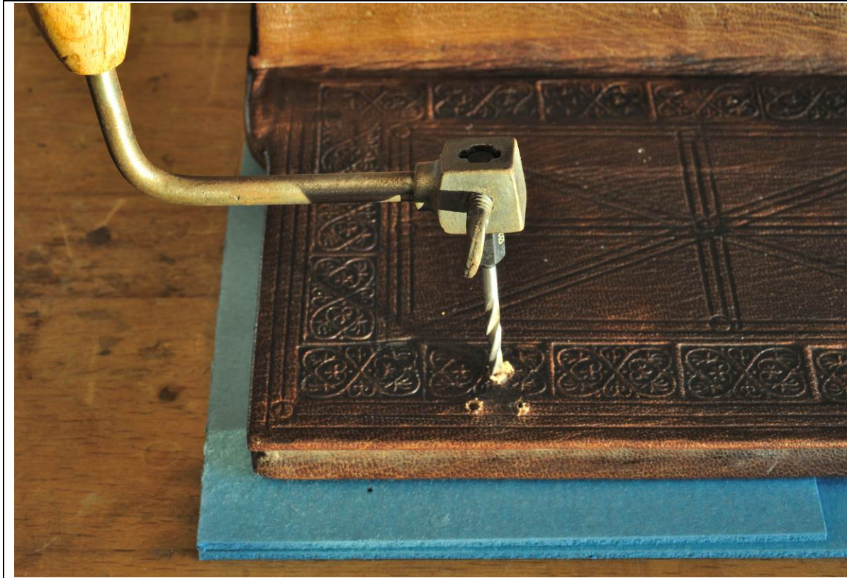
72_ Forage des ais pour le passage des lanières des fermeoirs.
