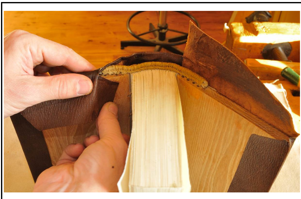
65_ Les remplis des coiffes sont ici découpés au moment de la couverture
