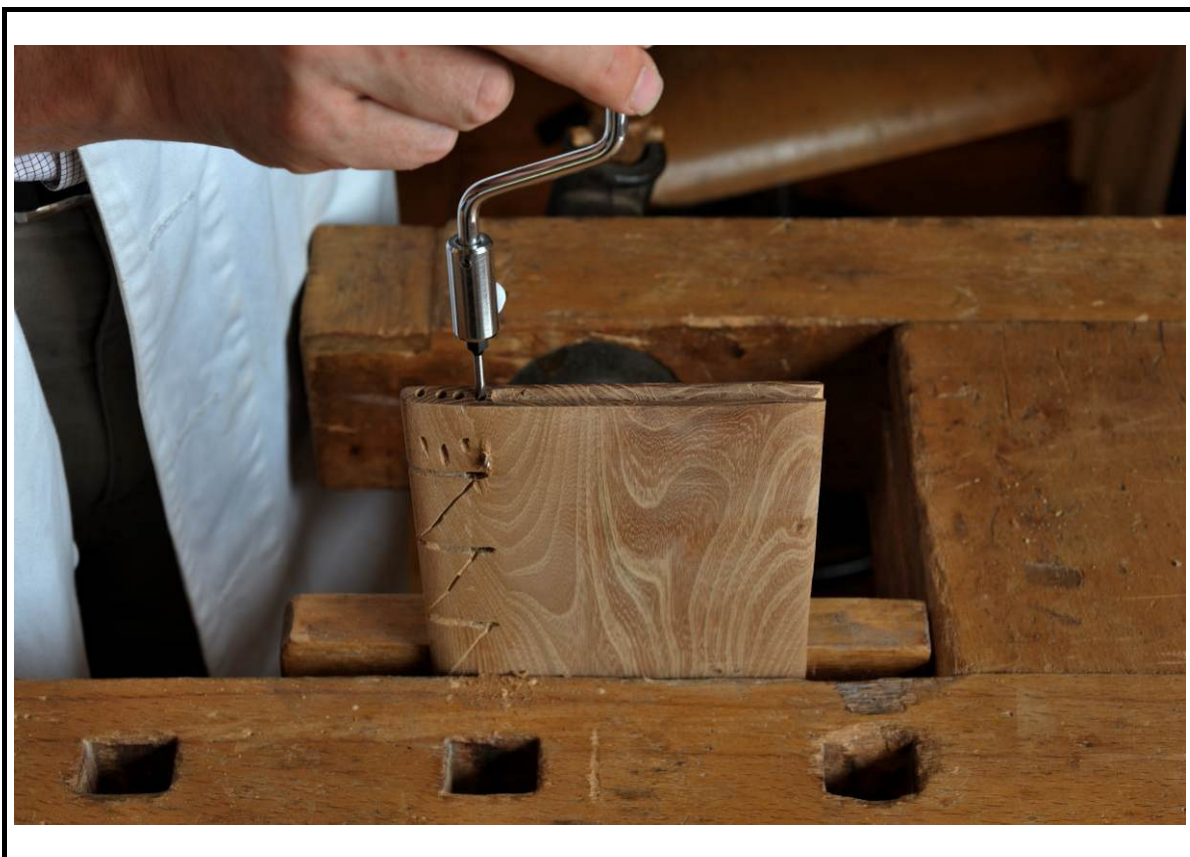
18_ Le forage des canaux pour les tranchefiles se fait à partir du milieu du chant vers l'extérieur. Les trous sont espacés de cinq millimètres. Ces forages peuvent être réalisés juste avant les tranchefiles
