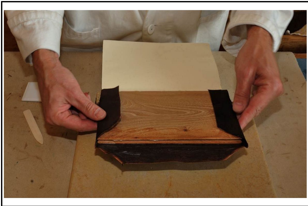
64_ Le dos de la couverture n'est pas collé sur le dos du bloc-livre, seuls les plats et les remplis sont encollés.
