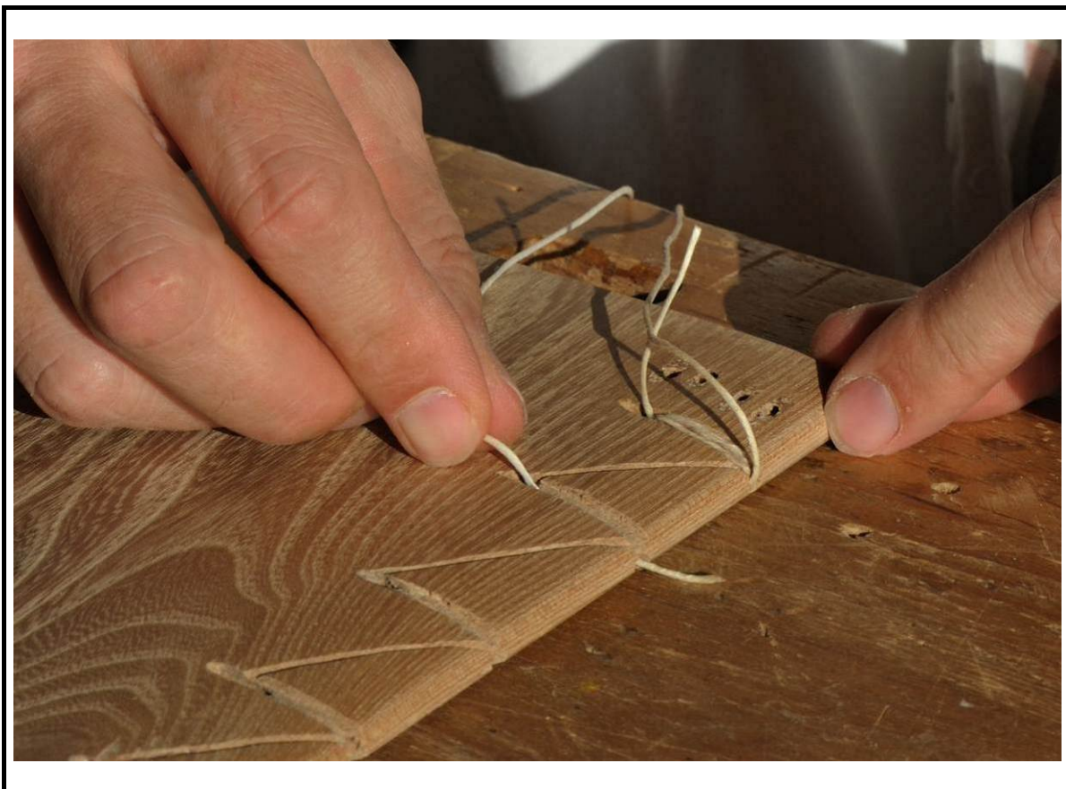
26 _Puis, en sortant côté mors, on va au trou suivant en se plaçant dans les canaux creusés dans le bois et ainsi de suite jusqu'au dernier trou.
