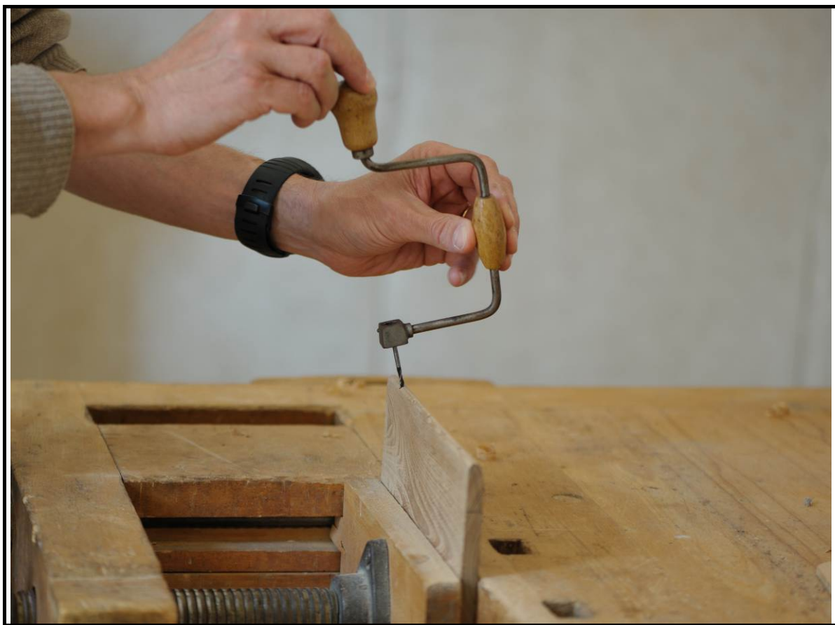
15_ Le forage des canaux pour la couture se fait avec un foret de trois millimètres; on part du chant côté mors en oblique pour ressortir sur la face externe du plat.
