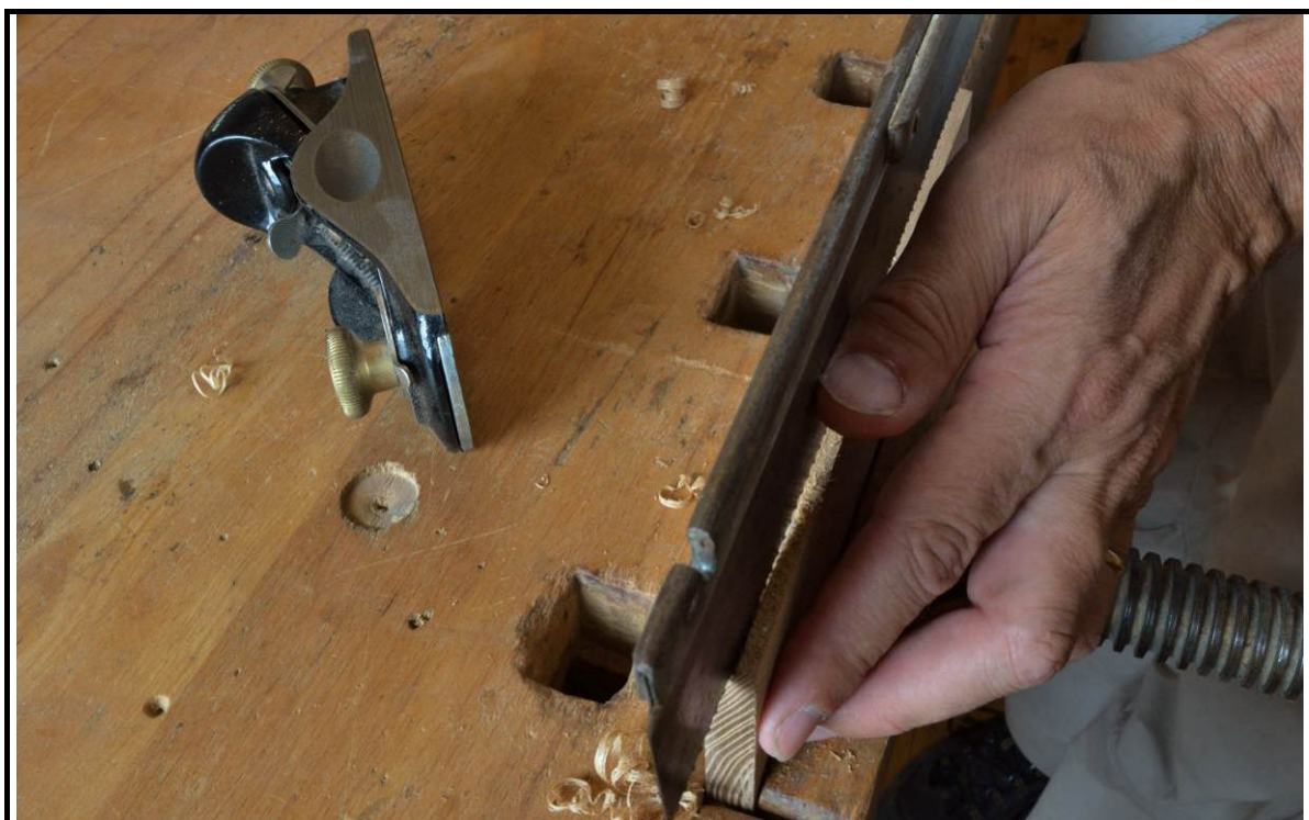
10 _Le façonnage des rainures sur les chants commence par une entaille à la scie d'une profondeur de quatre à cinq millimètres.
