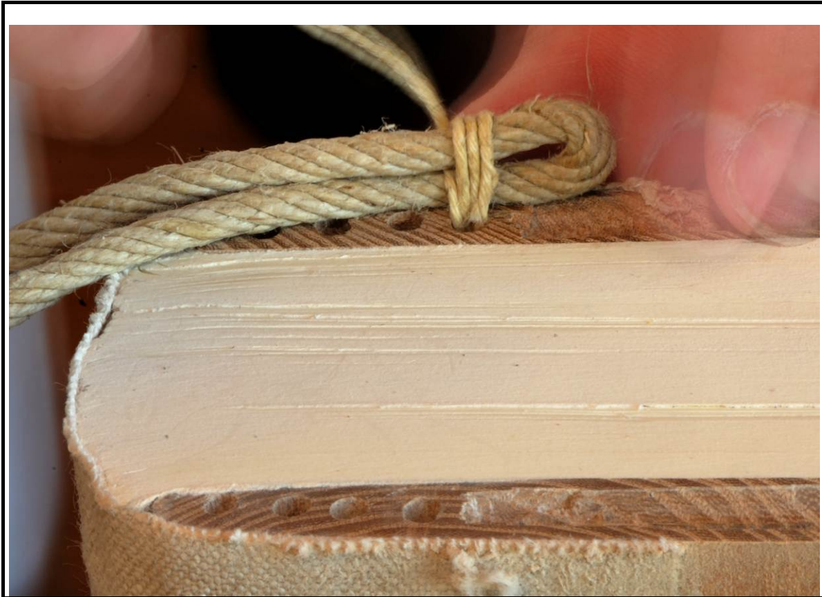
42 Après avoir entouré trois fois les septains, on passe l'aiguille entre les deux...
