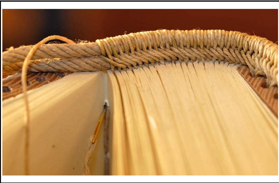
54_Puis l'aiguille passe dans la chainette, ainsi de suite
